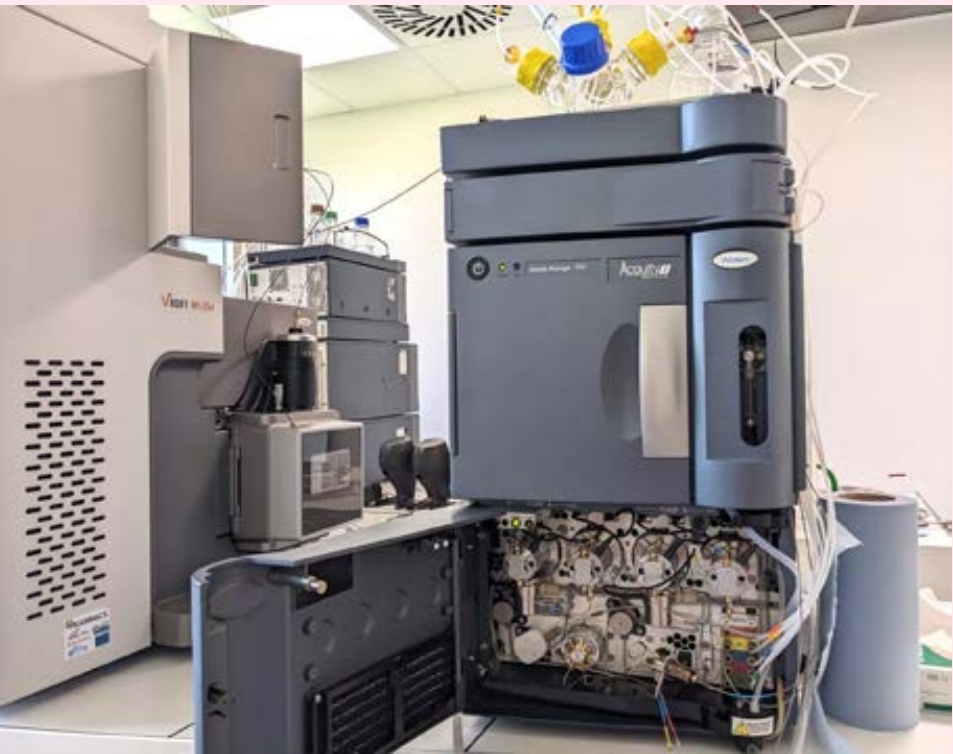
Instrument de chromatographie en phase liquide et spectrométrie de masse haute résolution pour la détection des micropolluants organiques.
