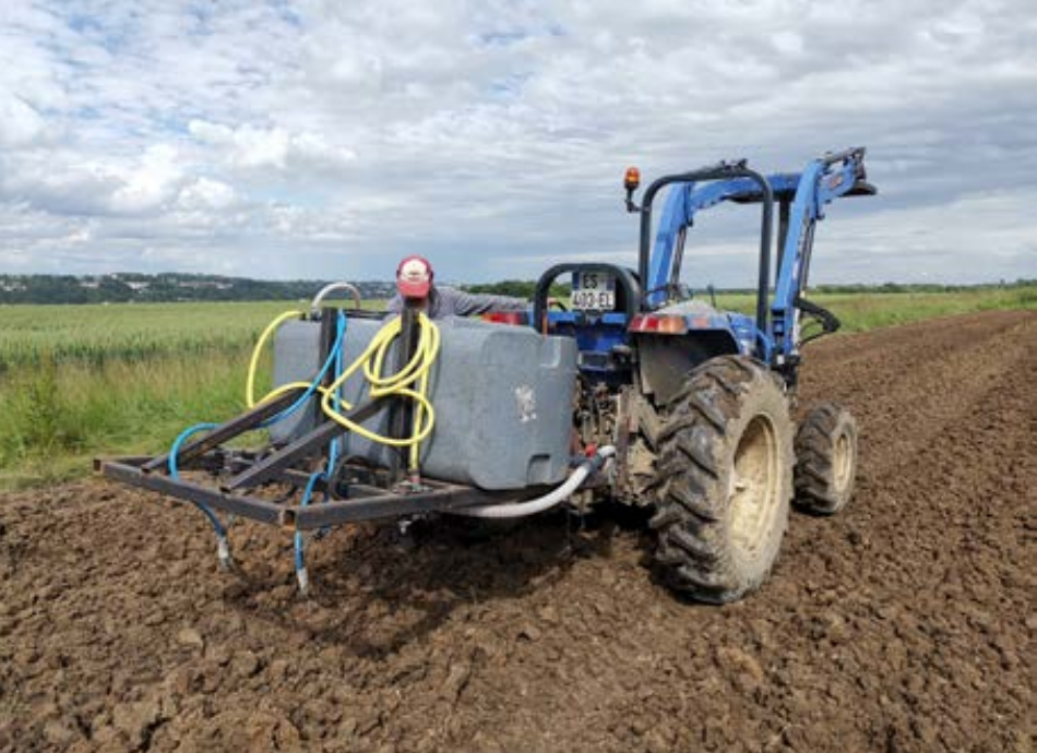
Le pipiculteur développé dans le projet Enville, un outil agricole à atteler à un tracteur, pour injecter du lisain sur des planches maraîchères avant plantation ou avant semis.
